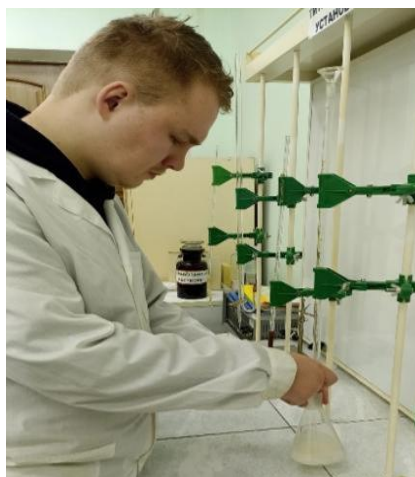
Рис. 3. Определение концентрации соли в сыре (фото автора)
